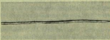
A. een binnenader, die gewoonlijk uit \pm 20 dunne, vertinde, koperen draadjes bestaat
